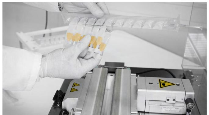
**Niente più sigillatura manuale.** È sufficiente inserire le guide con le fiale riempite nel sigillatore Jetrail®. Premendo **un pulsante**, 10 fiale vengono sigillate simultaneamente in soli 20-30 secondi. Le fiale possono essere etichettate e confezionate immediatamente.
