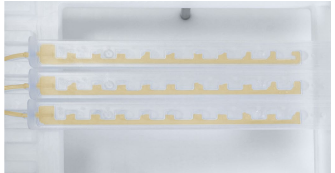
La guida brevettata Jetrail® per un riempimento uniforme delle fiale
